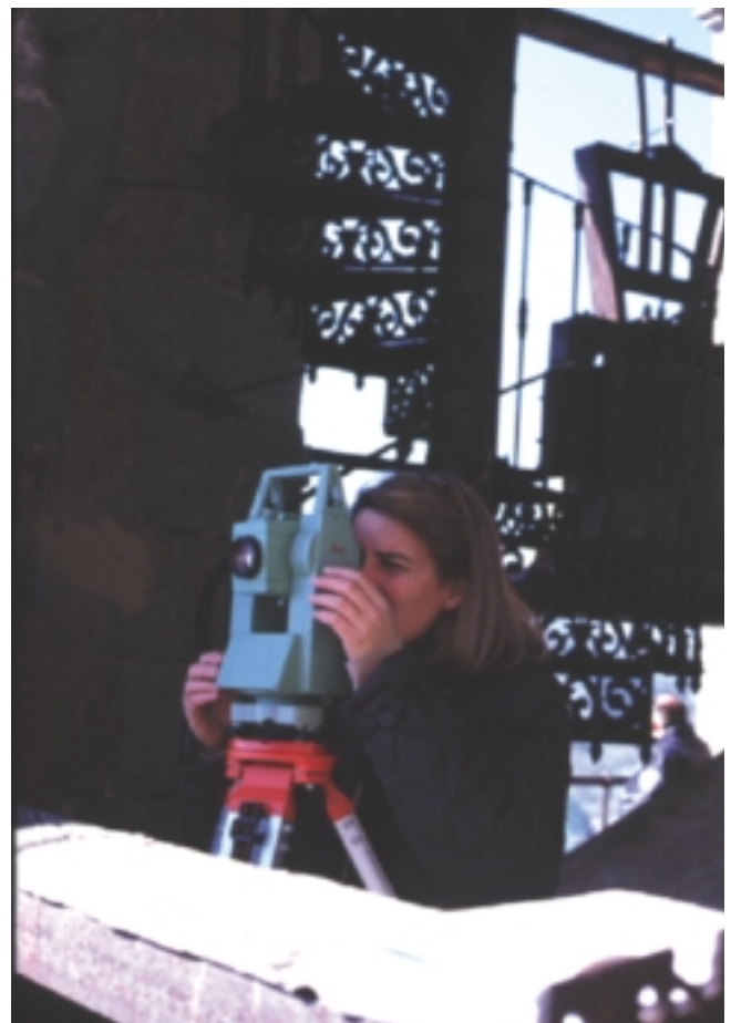
Estación Leica TCR 305 en campo
