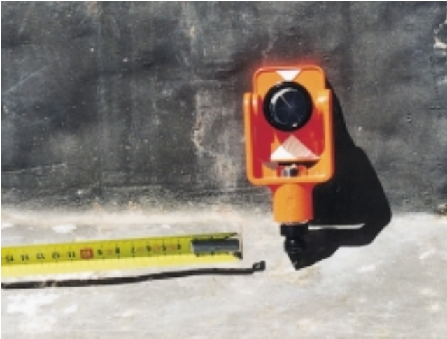
Miniprisma de 1" de diámetro montado sobre horquilla con nivel esférico y placa de puntería
