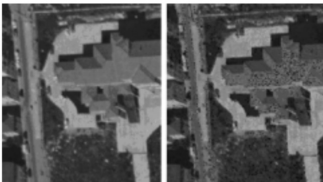
Figura 4. Efecto de huecos debidos a la función de escalado
