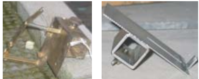
Fig. 8 y 9. Modelos para el soporte y disparo remoto, adaptado a dos cámaras fotográficas diferentes
