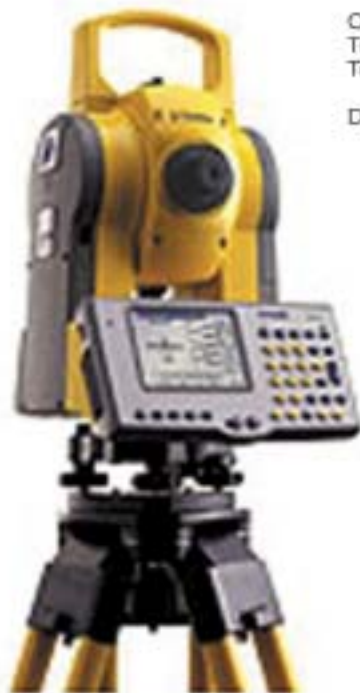
Estación Total Trimble 3600DR con ACU Precisión angular: 10"o Precisión en distancias: 2mm + 2ppm Alcance: 2.500 m Controlador ACU: con software Trimble Survey Controller Medición en prisma Disponible en 1000 y 1500
