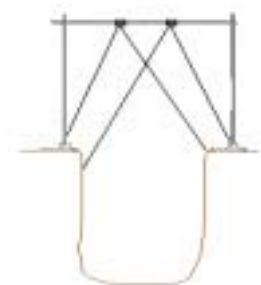
Fig. 11. Utilización para la fotografía de zanjas
