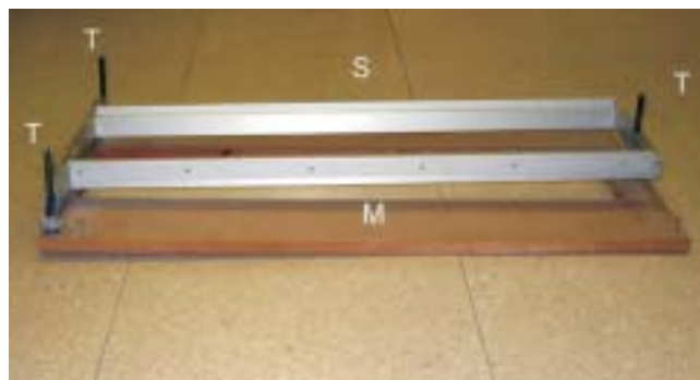
Fig. 1. Detalle del dispositivo de sustentación para UMK
