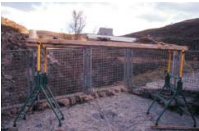
Fig. 2. Dispositivo de sustentación con UMK nivelado sobre el yacimiento paleontológico
