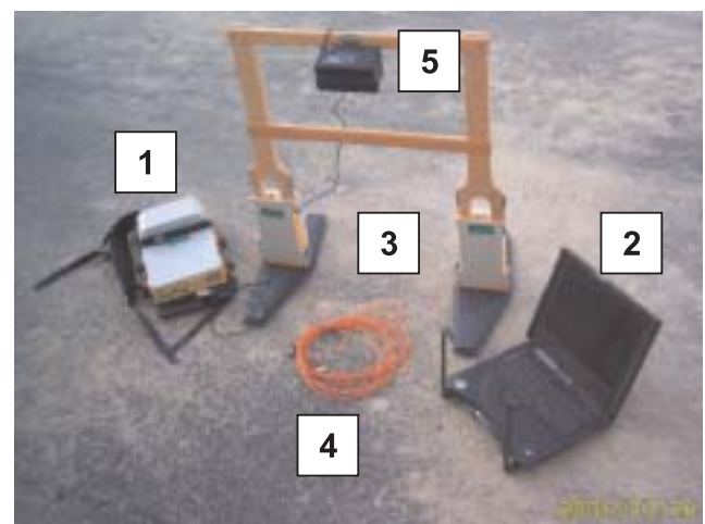
Foto 2. Montaje con antena 200 MHz
