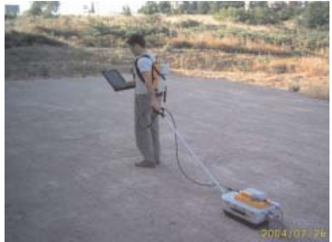
Foto 6. Toma de perfiles con antena Monoestática Apantallada 500 MHz
