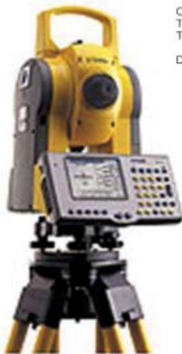
Estación Total Trimble 3600DR con ACU Precisión angular: 10cc Precisión en distancias: 2mm + 2ppm Alcance: 2.500 m Controlador ACU: con software Trimble Survey Controller Medición sin prisma Disponibles en 10cc y 15cc
