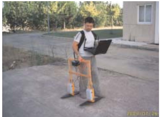
Foto 7. Toma de perfiles con antena Biestática No Apantallada 200 MHz
