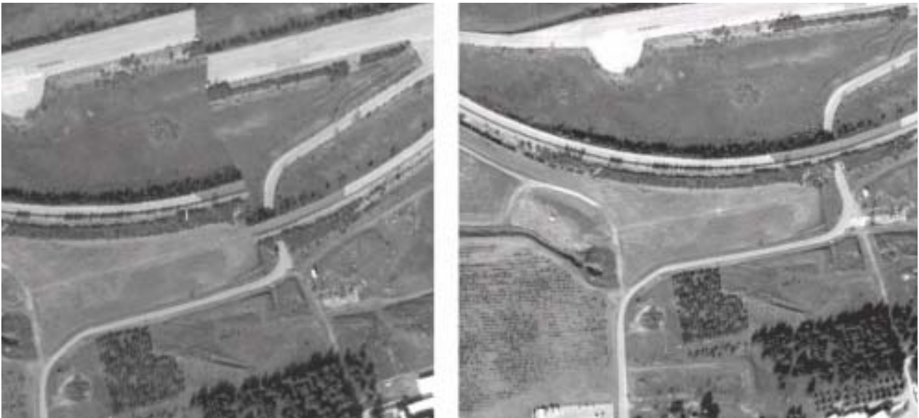
Figura 6. Ortoimagen de cámara digital sin calibrar y con calibración de boresight (Rejas, 2003)
