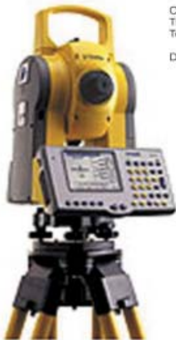
Estación Total Trimble 3306DR con ACU Precisión angular: 10cc Precisión en distancias: 2mm + 2ppm Alcance: 2.500 m Controlador ACU: con software Trimble Survey Controller Medición sin prisma Disponible en 10cc y 15cc
