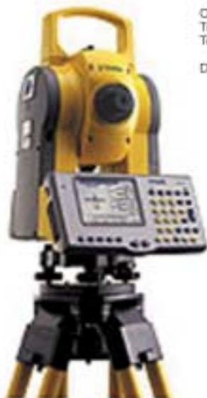
Estación Total Trimble 3300DR con ACU Precisión angular: 10cc Precisión en distancias: 3mm + 3ppm Alcance: 2.500 m Controlador ACU: con software Trimble Survey Controller Medición sin prisma Disponibles en 10cc y 15cc
