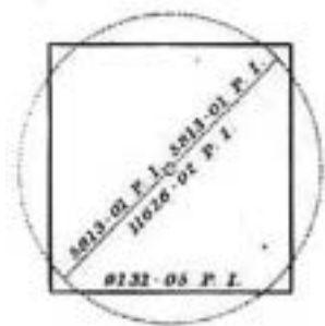
La base cuadrada de la pirámide y la circunferencia con radio igual a la altura de la misma. El dibujo acotado fue realizado por Piazzi Smyth.
