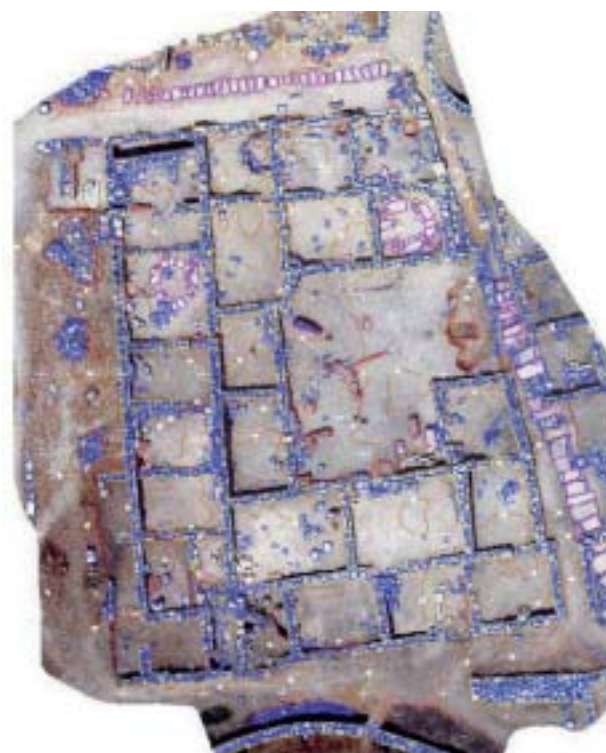
Figura 3: El mosaico final de Dilos, con la información vectorial y las curvas de nivel superpuestas (original a 1:100)
