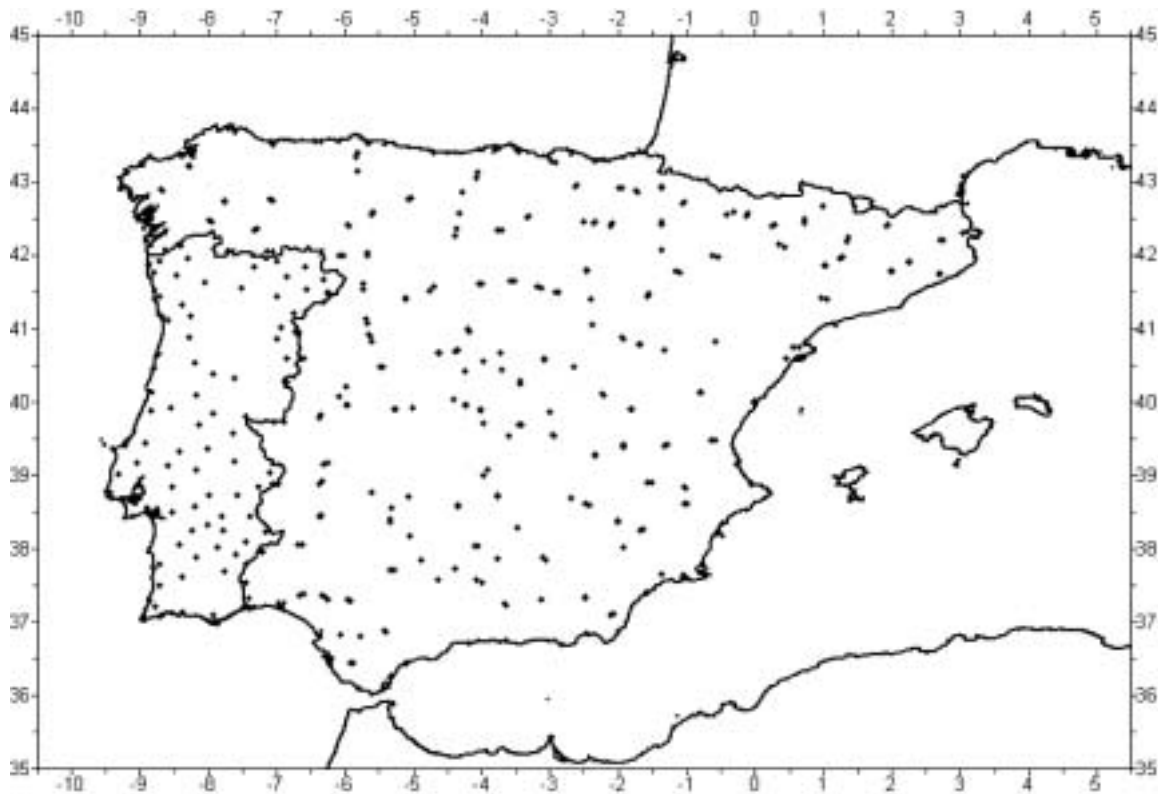
Figura 7 – Puntos GPS/Niv de control del geoido
