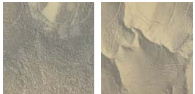
Figura 4: Izquierda: MDS de un bosque denso. Derecha: MDT derivado de la misma zona. (Cortesía DIELEMO)
