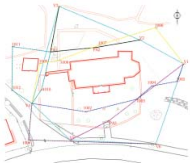
Figura 1. Distribución de estaciones utilizadas y croquis de la zona radiada
