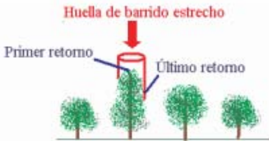
Figura 1: Huella de un LIDAR de barrido estrecho
