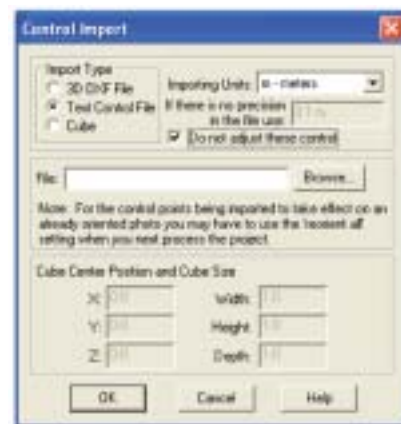
Figura 21. Ventana de importación de puntos de apoyo en PhotoModeler
