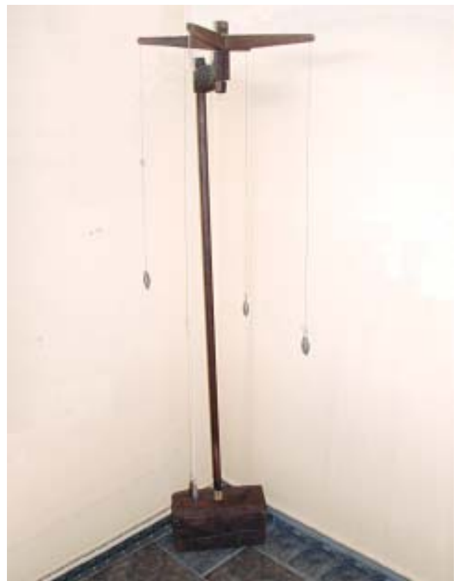
Propuesta de reconstrucción de la groma en la obra de Adam. A la derecha, prototipo construido con finalidad divulgativa basado en el diseño de Adam.
