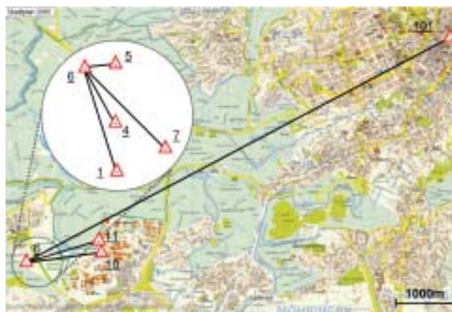
Figura 10. Configuración de la medición de líneas base en una zona de la ciudad de Stuttgart
