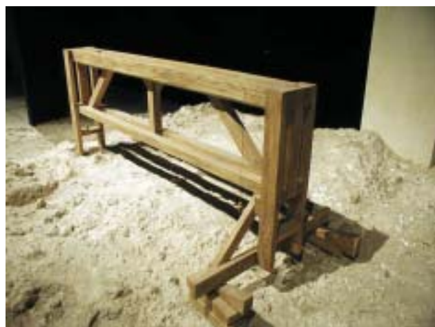
A la izquierda, corobate construido por Adam y ensayado en Pompeya. A la derecha uno de los muchos corobates tipo mesa de metro y medio de longitud, tipo Adam, que hoy pueden verse reconstruidos con fines divulgativos. Éste, en el museo-exposición del Pont de Gard (Nimes-Francia).
