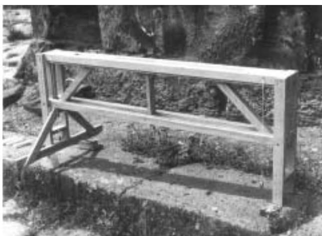
A la izquierda, corobate construido por Adam y ensayado en Pompeya. A la derecha uno de los muchos corobates tipo mesa de metro y medio de longitud, tipo Adam, que hoy pueden verse reconstruidos con fines divulgativos. Éste, en el museo-exposición del Pont de Gard (Nimes-Francia).
