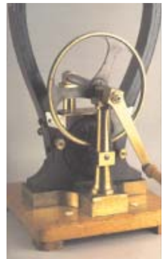
Dos vistas de la máquina magneto eléctrica de Gramme construida por la casa Bréguet de París. Tales generadores, con lámparas de Serrin adaptadas a los mismos, se instalaron en las cuatro estaciones del enlace hispano argelino.
