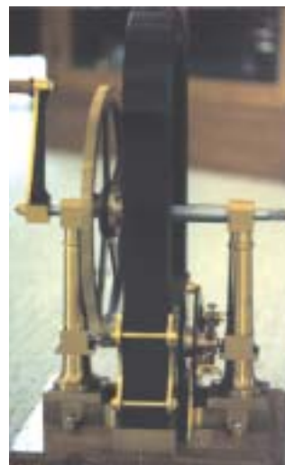
Dos vistas de la máquina magneto eléctrica de Gramme construida por la casa Bréguet de París. Tales generadores, con lámparas de Serrin adaptadas a los mismos, se instalaron en las cuatro estaciones del enlace hispano argelino.
