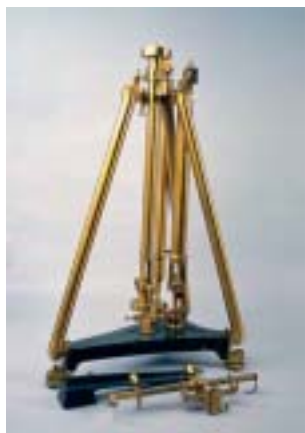
Péndulo construido por Repsold & Söhne (Hamburgo 1878) y usado por Barraquer para la determinación absoluta de la gravedad en el pilar del Observatorio Astronómico de Madrid. A la derecha se muestra el equipo pendular de Sterneck empleado por O. Hecker
