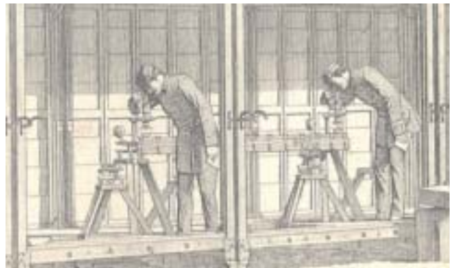
Detalle de la medida efectuada en la Base de Madrudejos con la regla de la Comisión del Mapa, la ilustración original forma parte de la publicación realizada al efecto por Saavedra e Ibáñez: Base central de la triangulación geodésica de España, editada por Rivadeneyra. Madrid (1865)
