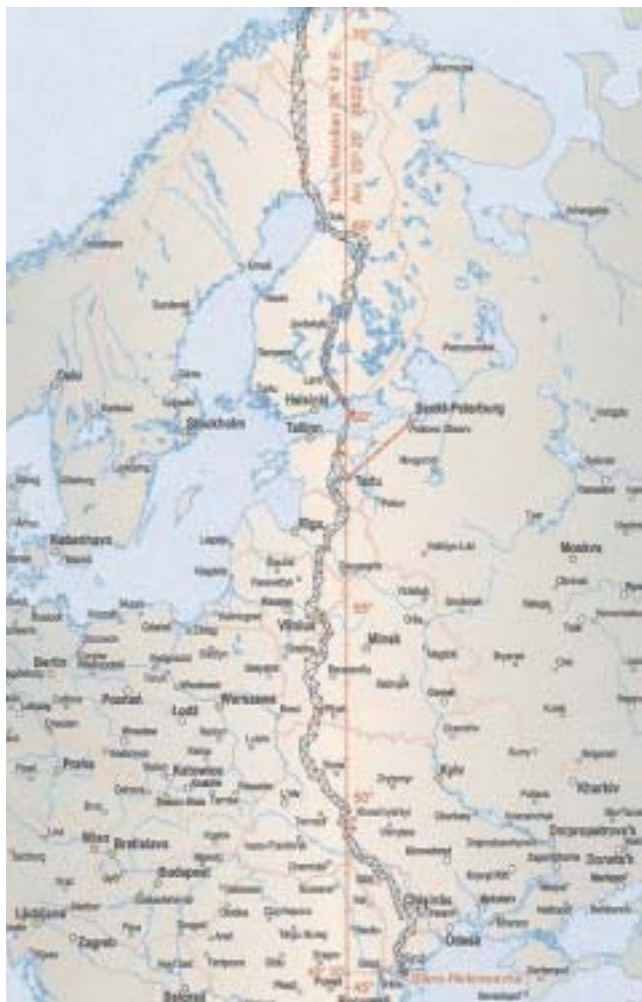
El gran arco ruso-escandinavo de Struve con un desarrollo cercano a los 2820 kilómetros, los triángulos de la cadena tuvieron una longitud media de 30 kilómetros. En la foto de la derecha aparece el monumento colocado en Fuglenes (Noruega) la estación más septentrional del arco
