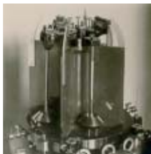
Péndulo construido por Repsold & Söhne (Hamburgo 1878) y usado por Barraquer para la determinación absoluta de la gravedad en el pilar del Observatorio Astronómico de Madrid. A la derecha se muestra el equipo pendular de Sterneck empleado por O. Hecker
