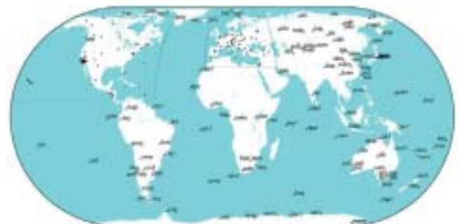
Figura 2. Red mundial de estaciones GPS de seguimiento IGS (Cortesía de la página Web del IGS)
