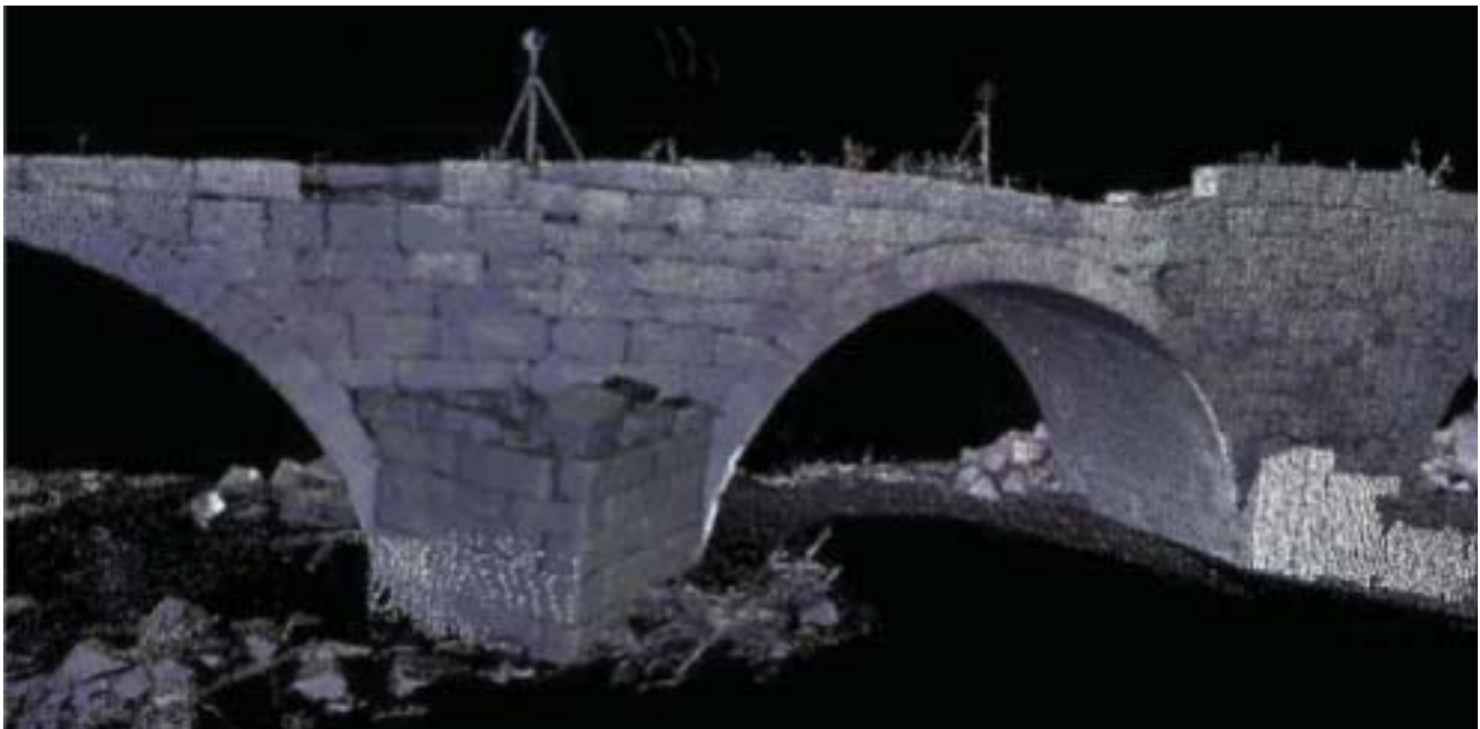
Figura 5. Nube de puntos capturada con el equipo HDS. Vinuesa, Soria
