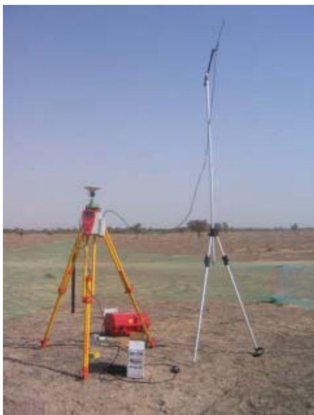
Figura 3. Estación fija de referencia. al-Madam, Sharjah (E.A.U.)
