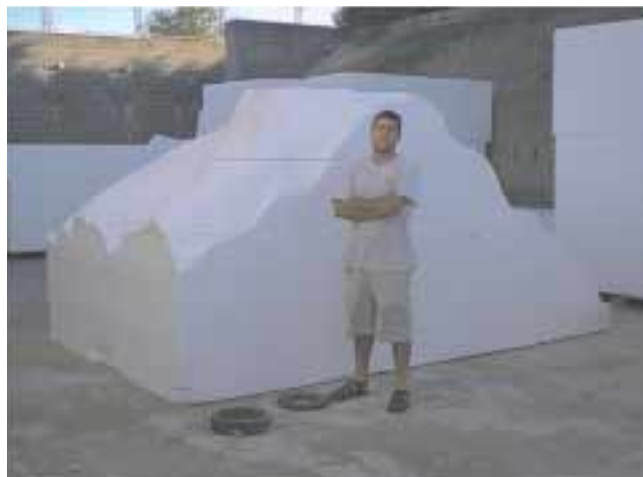
Figura 4 Vista de uno de los moldes listo para el montaje
