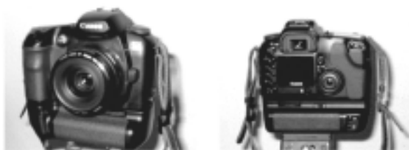
Figura 1. Cámara digital réflex Canon EOS D30. Se muestra también la empuñadura con las unidades de batería adicionales
