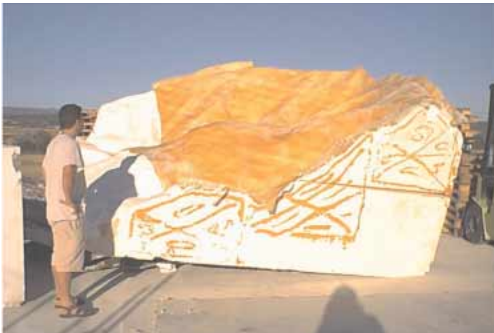
Figura 5. Varios de los moldes unidos para proyectar Poliéster
