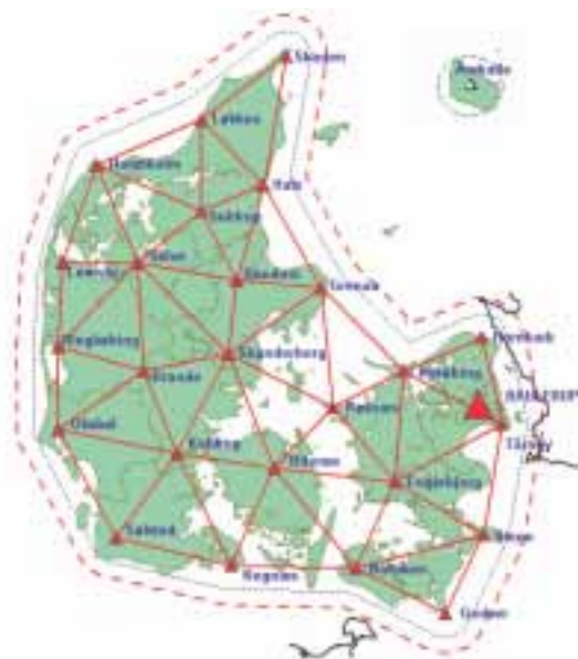
Figura 6: Red VRS en Dinamarca con GPSNet de Trimble http://www.GPSNet.dk
