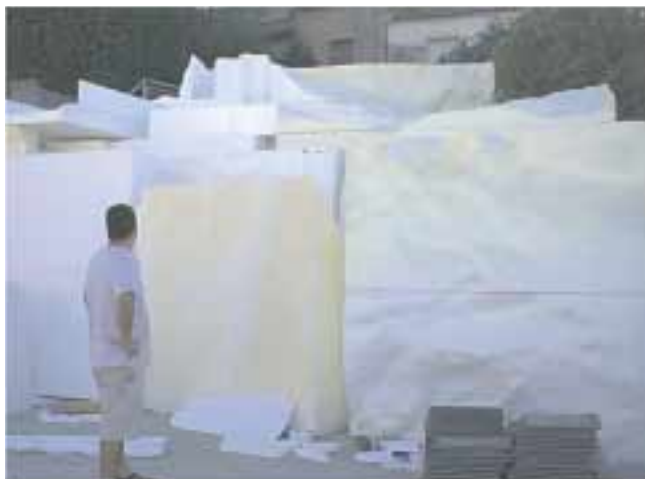
Figura 1. Poliestireno utilizado para la talla de los módulos por la fresadora
